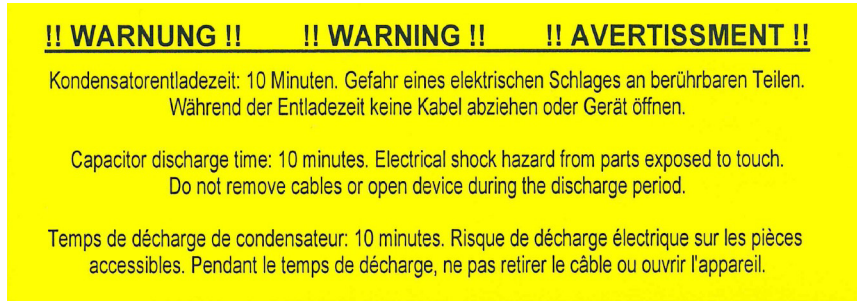
Abbildung 1: Warnetikette Kondensatorentladezeit
